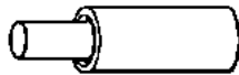
Y.20569 Schläger für Torsionsdämpfer Hinterrad Outil d'extraction et de pose du flecteur de roue arrière Drift for torsion damper rear wheel
